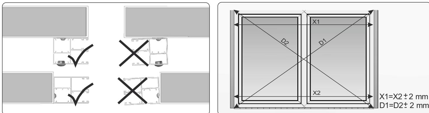
Die nicht sachgerechte Einstellung der Anschlüsse in Führungen des Insektenschutzgitters gegeneinander kann Probleme mit sachgerechter Funktion des Anschlusses des Insektenschutzgitters verursachen (z.B. eine Seite der Endleiste des Insektenschutzgitters wird mit dem Anschluss verbunden und die andere nicht).
