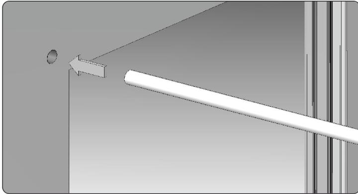
9. Nach der Ausführung einer Öffnung für den Gurt ist in die Öffnung ein Rohr, z.B. PVC mit Durchmesser 20 mm einlegen und dieses bündig mit der äußeren Mauerfläche abschneiden. Innen muss das Rohr um 2 cm kürzer als die Mauerfläche für den Bau der Gurtdurchführung, sein.
