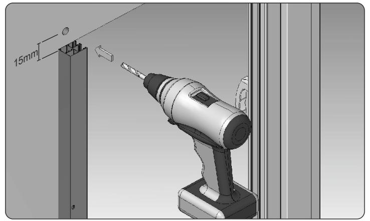
8. An der Wand die Durchbohrstelle für Gurt, Schnur oder Kabel markieren. Anschließend Öffnungen 1,5 cm oberhalb des Oberteils der Führung in der Mitte der Kammer, in der der Kastenfuß eingeführt wird
