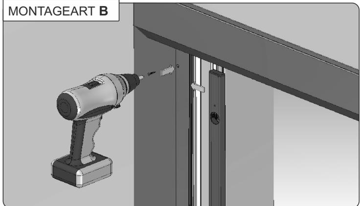
10. Mit der Wasserwaage die Führungen an die einzubauende Fläche verschrauben und ausgleichen.
