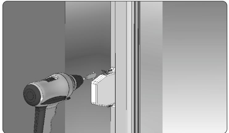
13. Den Rollladenpanzer absenken und dann die Schnur auf die Länge von 25 cm unterhalb der Montagestelle des Wicklers abschneiden. Nach der Durchführung der Schnur durch die Öffnung des Wicklers das Ende mit Feuerzeug versengen; dies verhindert Lösen der Schnur. Den Wickler schließen und diese an der Wand befestigen (siehe die Montageanleitung des Schnurwicklers).
