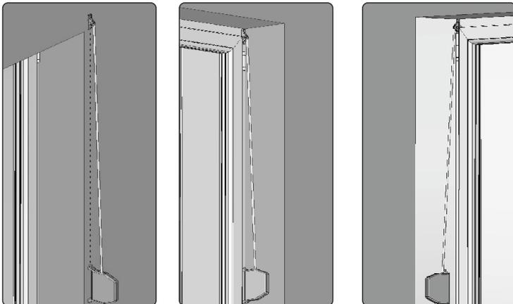
12. Den Wickler mit den Schrauben an der Wand oder an einen Fensterrahmen, senkrecht gegenüber dem Ausgang der Schnur aus der Durchführung verschrauben. Der Wickler soll sich auf der Höhe von nicht mehr als 1,8 m vom Untergrund befinden.
