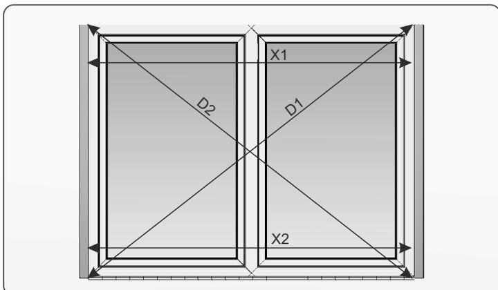
12. Maß X1 und X2 der Führung unten und oben sowie zwei Diagonalen D1 und D2 messen - die Abweichung zwischen den Maßen X1 und X2 sowie D1 und D2 soll 2 mm nicht überschreiten
