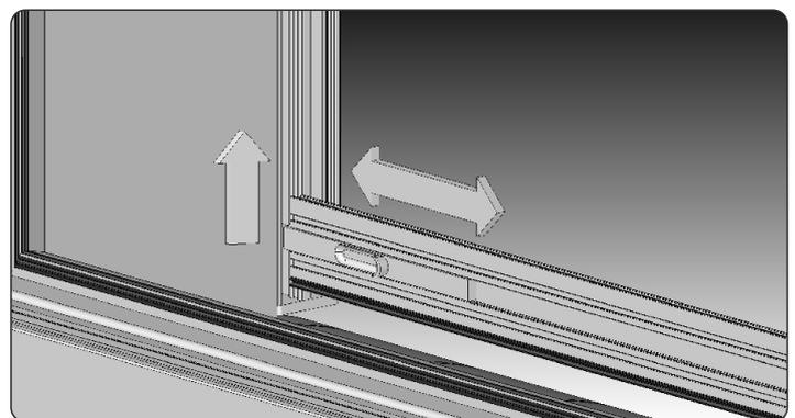
Nach der sachgerechten Montage und Einstellung des Insektenschutzgitters soll dieses fließend laufen und kein Runzeln des Netzes verursachen. Nach dem Absenken des Insektenschutzgitters soll sich die untere Leiste ohne Probleme öffnen und schließen.
