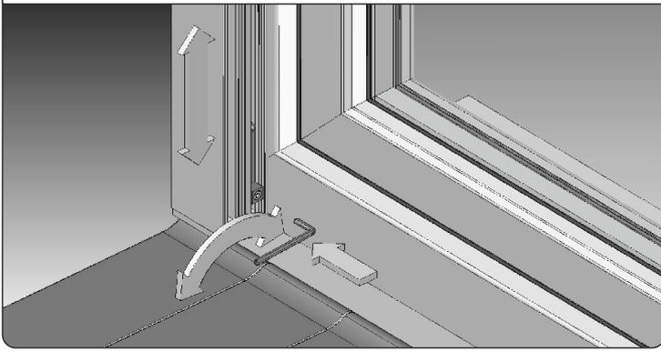
...Nach dem Lösen der Innensechskantschrauben mit dem Schlüssel 2 mm mit den Schraubendreher die Anschlüsse unten oder oben verschieben. Bei dem KLIK-KLAK-System die Schraube mit dem Innensechskantschlüssel 3 mm lösen und die gewünschte Höhe einstellen
