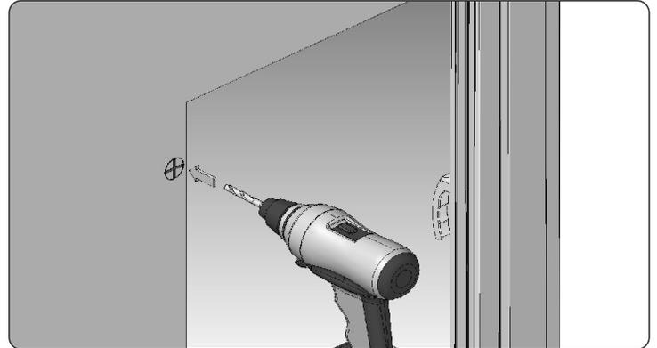
10. In markierten Stellen an der Wand Öffnungen für Spreizdübel bohren. Die Länge und die Art an die Art des Untergrundes anpassen. Stifte in gebohrten Öffnungen einlegen.
