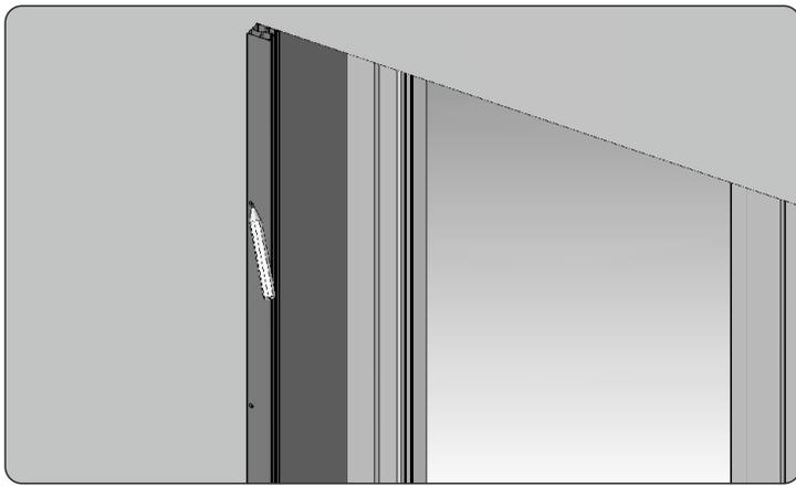
7. Die angebohrten Führungen an die Wand anliegen und die Öffnungen für Montageschrauben markieren.
