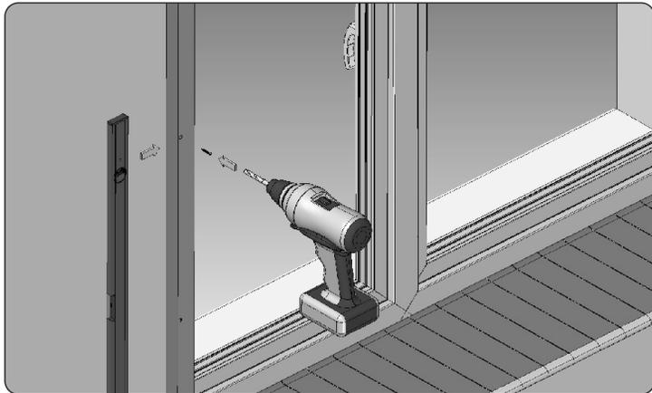
11. Mit der Wasserwaage die Führungen an die einzubauende Fläche verschrauben und ausgleichen. Bei den Rollläden mit dem Insektenschutzgitter ist darauf zu achten, dass die Führungen mit entsprechender Seite angebracht werden, so dass die Anschlüsse des Riegels vom Insektenschutzgitter oder Anschlüsse des KLIK-KLAK-Systems sich im Unterteil der Führung befinden
