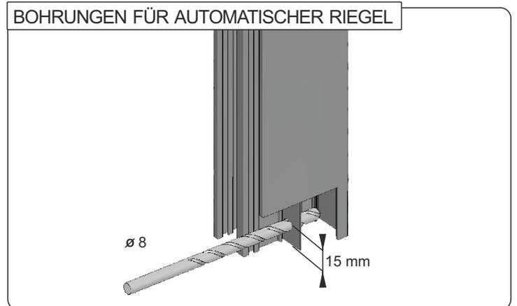
4. Bei dem Einbau des Rollladens mit automatischen Riegeln den Mittelteil der Führung mit dem Bohrer mit dem Durchmesser 8 mm in der Entfernung von 15 mm von der unteren Kante durchbohren.
