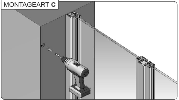
...bei der MONTAGEART C - in markierten Stellen an der Wand Öffnungen bohren.
