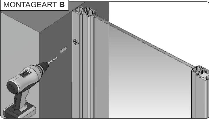
5. In markierten Stellen am Fensterrahmen Öffnungen für Schrauben bohren. Die Länge und die Art an die Art des Untergrundes anpassen. Stifte in gebohrten Öffnungen einlegen...
