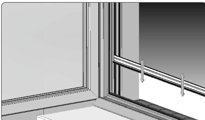
18. In Rollläden mit Insektenschutzgitter die sachgerechte Funktion des Insektenschutzgitters prüfen. Dieses soll fließend arbeiten und keines Runzeln des Netzes verursachen. Nach dem Absenken des Insektenschutzgitters soll sich dieses im Unterteil der Führungen einrasten.
