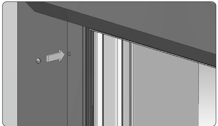
11. Sich vergewissern, dass der Rollläden sachgerecht (waagrecht und senkrecht) befestigt ist. Die Schrauben in Führungen festdrehen und dann die Abdeckungen einlegen. Die sachgerechte Funktion des Rollladens prüfen. Die sachgerechte Funktion der automatischen Riegel oder des Verschlusses prüfen, bei Bedarf regeln.
