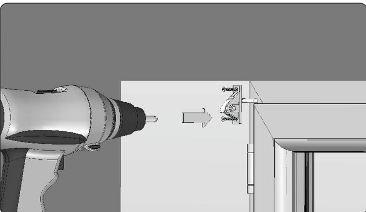
9. Das Schnur durch die Durchführung führen und dann die Durchführung mit dem Spreizdübel an der Wand befestigen.
