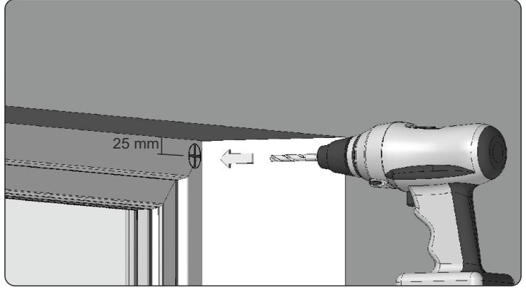
7. Bei der Montageart in der Nische empfiehlt die als den manuellen Antrieb einen Schnurwickler anzuwenden. Am Fensterrahmen die Bohrstelle für Schnur oder Kabel markieren. Anschließend Öffnung 2,5 cm unterhalb des Oberteils der Nische bohren. -für Schnur - mit Bohrer mit Durchmesser 12mm -für Versorgungsleitung für Motor- mit Bohrer mit Durchmesser 10mm
