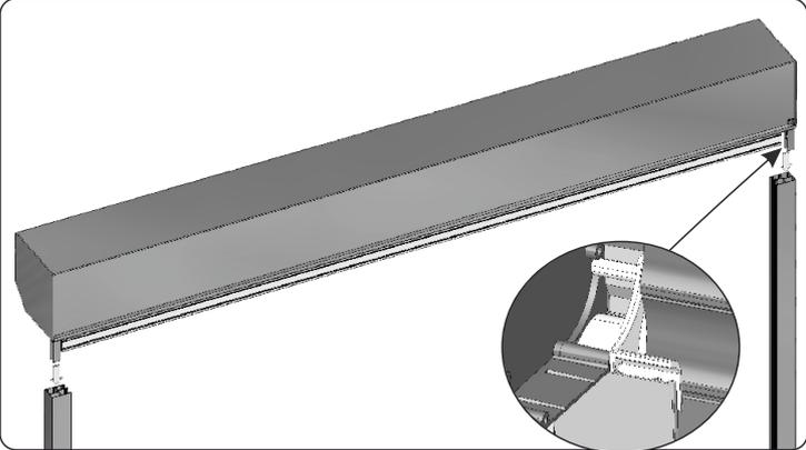
6. Präzise den Kasten auf die Führung verschieben, dabei die Bolzen der Seiten in den Oberteil der Führungen sorgfältig einführen. Bei den Rollläden mit Insektenschutzgitter sorgfältig die untere Leiste auf eine solche Art und Weise einschieben, so dass das Netz nicht beschädigt ist und darauf achten, dass die Anschlüsse des Riegels vom Insektenschutzgitter oder Anschlüsse des KLIK-KLAK-Systems sich im Unterteil der Führung befinden.
