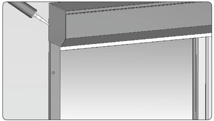
20. Es empfiehlt sich nach dem Einbau die oberen und unteren Spalten zwischen der Mauer und dem Rollladen mit Silikon füllen, um zusätzliche Abdichtung und Wasserschutz sicherzustellen.
