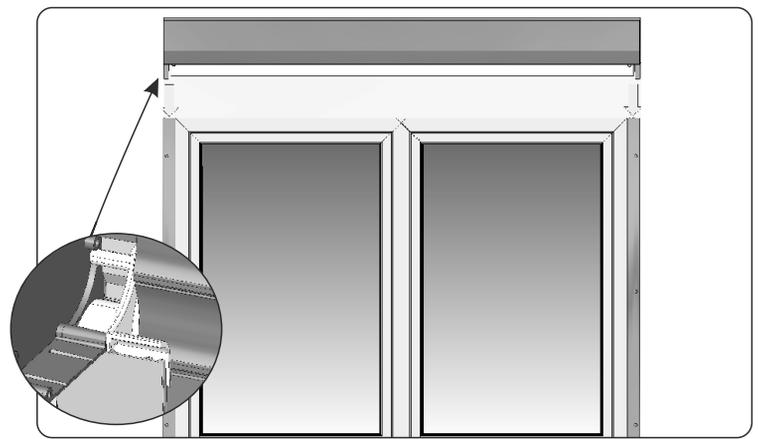
14. Den Kasten genau auf die Führung verschieben, sorgfältig die Bolzen der Seiten in den Oberteil der Führungen einführen. Bei den Rollläden mit dem Insektenschutzgitter sorgfältig die untere Leiste auf solche Art und Weise einschieben, dass das Netz nicht beschädigt ist.
