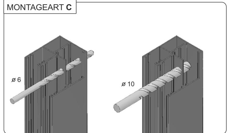
1. Öffnungen in Führungen anbohren. Mit dem Bohrer mit Durchmesser 6 mm eine Öffnung über die zwei Kammern der Führung ausführen und mit dem Bohrer mit dem Durchmesser 10 mm die Öffnung nur in der ersten Kammer von der äußeren Seite der Führung zu vergrößern (MONTAGEART C - die Öffnung in der Mittelwand der Führung vergrößern).
