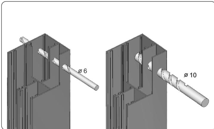
3. Öffnungen in Führungen anbohren. Mit dem Bohrer mit Durchmesser 6 mm eine Öffnung über die zwei Kammern der Führung ausführen und mit dem Bohrer mit dem Durchmesser 10 mm die Öffnung in der ersten Kammer von der äußeren Seite der Führung vergrößern
