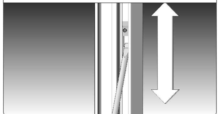
19. Die Höhe der Verschlusses des Insektenschutzgitters kann man regeln, indem man die sich im Unterteil der Führungen befindlichen Verschlussanschlüsse des Insektenschutzgitters verschiebt...
