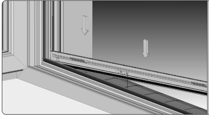
Falsche Führungsschienenmontage kann der Grund für fehlerhaftes Funktionieren vom System **KLIK-KLAK** sein.
