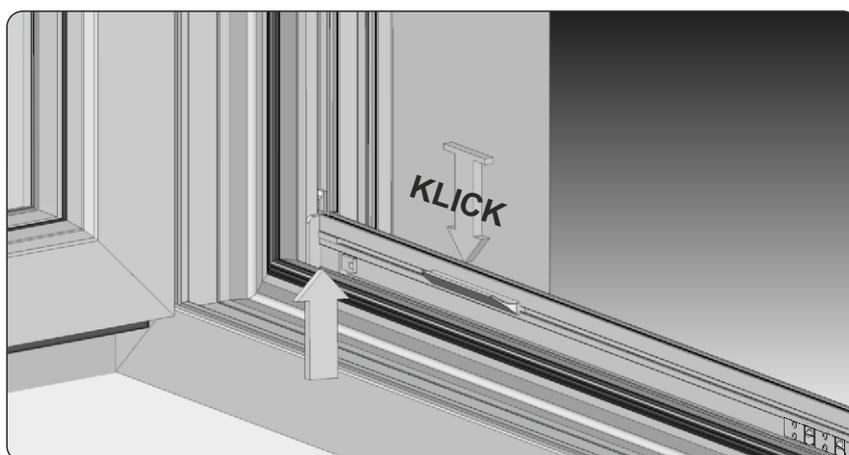
Nach der richtigen Montage und Regulierung soll das ISG gleichmäßig laufen, ohne das Gitter zu falten.
