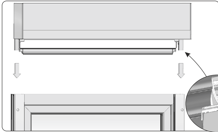
9. Präzise den Kasten auf die Führung verschieben, dabei die Bolzen der Seiten in den Oberteil der Führungen sorgfältig einführen. Sorgfältig die untere Leiste auf solche Art und Weise einschieben, dass das Netz des Insektenschutzgitters nicht beschädigt ist.
