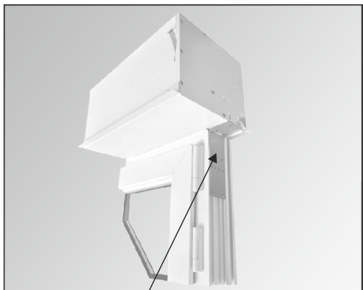
AUFSATZROLLLADEN TL1000 MIT KASTENVERBREITERUNG Min. Breite der Verbreiterung - 5,5 cm Unterhalb 5,5 cm gibt es die Kastenverbreiterung mit zulaufendem Plexiglas, in dem kein Motor einzubauen ist.
