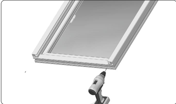
11. Untere Endkappen auf Führungsschienen aufsetzen und mit einer Schraube verschrauben.
