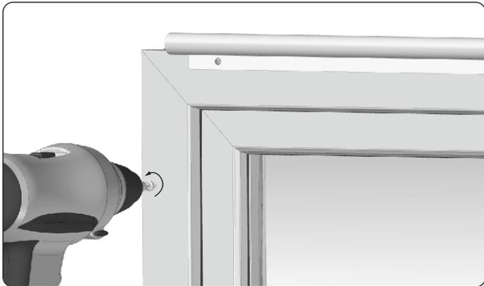
3. Die Befestigungsschrauben (Nippel) sollen durchschnittlich alle 50 cm, mindestens aber 3 Schrauben pro Seite und mindestens 5 cm von der Unter- und Oberkante des Fensterrahmens montiert werden. Sobald die Schraube angezogen wird, um 1/4 Drehung lösen, sodass die Führungsschiene leichter eingeschoben werden kann.
