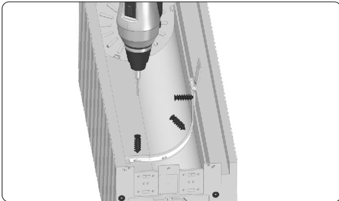
13. Die Statikkonsole mit den im Lieferumfang enthaltenen Befestigungsschrauben aus Kunststoff an den Kasten befestigen.
