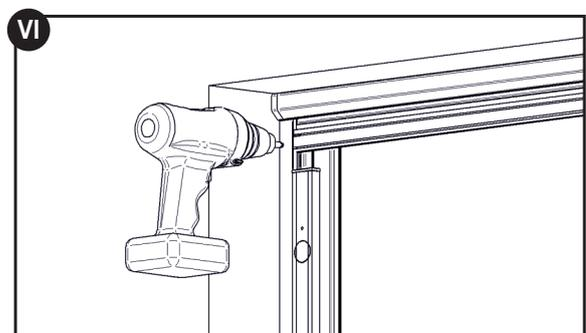
6. Legen Sie das Insektenschutzrollo an den Fensterrahmen, prüfen Sie das Rollo auf seine waage- und senkrechte Position und fixieren Sie es an den Rahmen.
