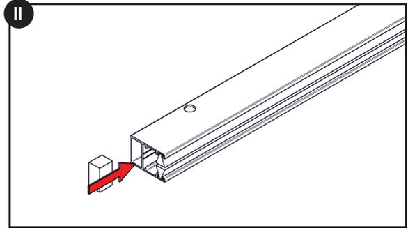
2. Stecken Sie die Abschlusskappen in die Führungsschienen ein.
