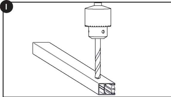
1. Bohren Sie die Öffnungen in den Führungsschienen im Abstand von ca. 5 cm vom oberen und unteren Rand sowie im Abstand von 30-50 cm zwischen den Öffnungen.
