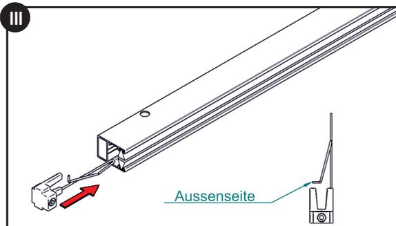
3. Stecken Sie den Klick-Klak-Haken in die Führungsschienen mit der richtigen Seite von unten ein.
