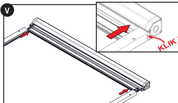
5. Setzen Sie den Rollokasten mit Insektenschutz auf die Führungsschienen.
